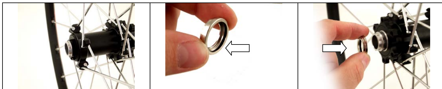
4 Procúrese el KIT en cuestión. 5 Revise que la junta tórica esté dentro del adaptador. 6 Monte el adaptador en el eje del buje.
